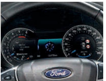
**TFT zaslon u boji od 10,1 inča na ploči s instrumentima**
