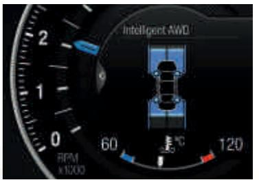
Poseban zaslon na sklopku instrumenata prikazuje raspodjelu snage između svih četiriju kotača.
