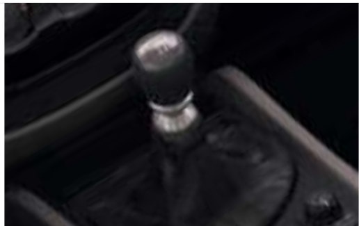
Ručni mjenjač sa 6 stupnjeva prijenosa Poboljšana štednja goriva i veće ubrzanje iz mirovanja potpuno natovarenog vozila. (Standardno)
