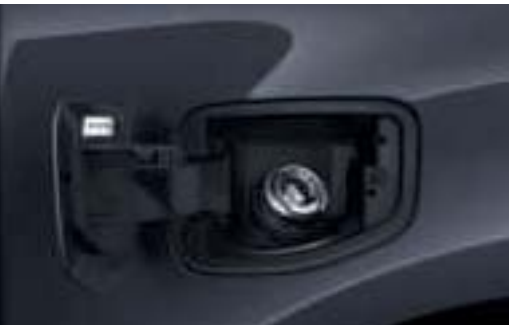
Ford Easy-Fuel sustav nadopune goriva bez čepa Sprječava ulijevanje neispravne vrste goriva. (Standardno)
