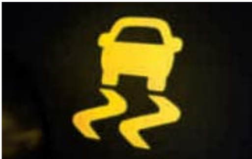
Elektronički stabilizacijski program (ESP) Uključuje kontrolu proklizavanja i pomoć pri kočenju u nuždi (EBA). (Standardno)
